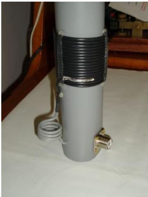
Foto 2 (Particolare dell'avvolgimento TUNING COIL)
